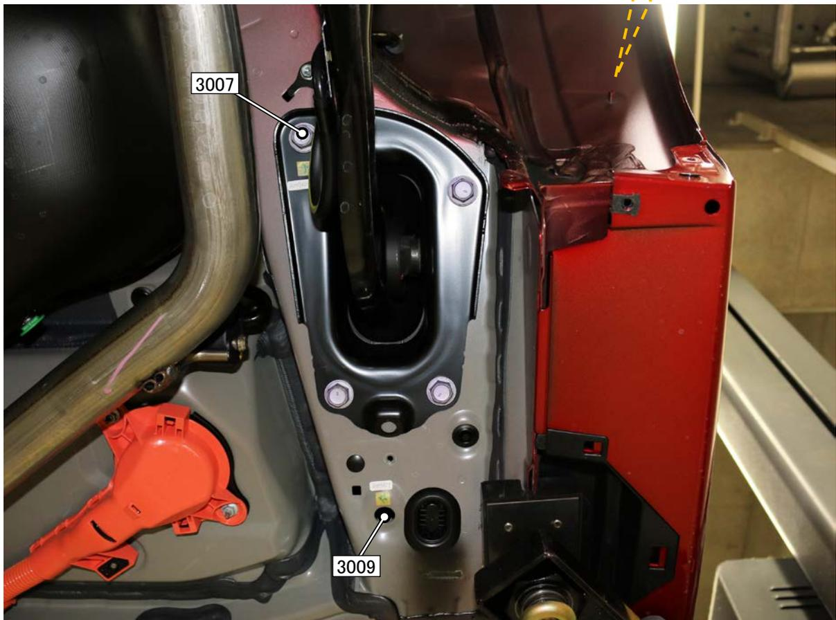
【計測点の形状】 3003 ボルト先端、3006 ボルト頭、3007 ボルト頭、3009 穴、3102 ボルト先端、3105 ボルト頭、3106 ボルト頭、3108 穴、3201 ボルト頭、3202 ボルト頭、3203 ボルト頭、3204 ボルト頭
