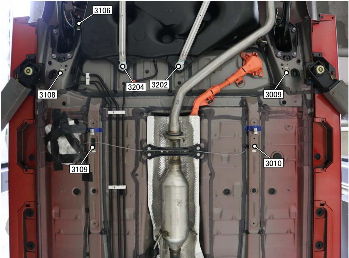
【計測点の形状】 3008 パネル端、 3009 穴、 3010 穴、 3106 ボルト頭、 3108 穴、 3109 穴、
