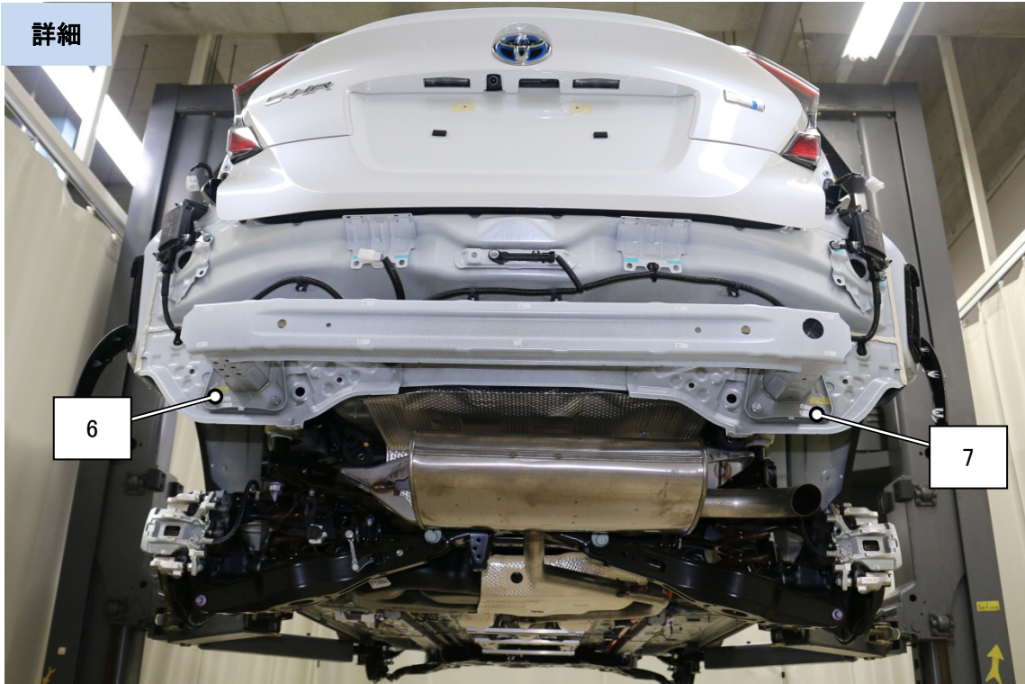
【計測点の形状】 6 ボルト頭、7 ボルト頭
