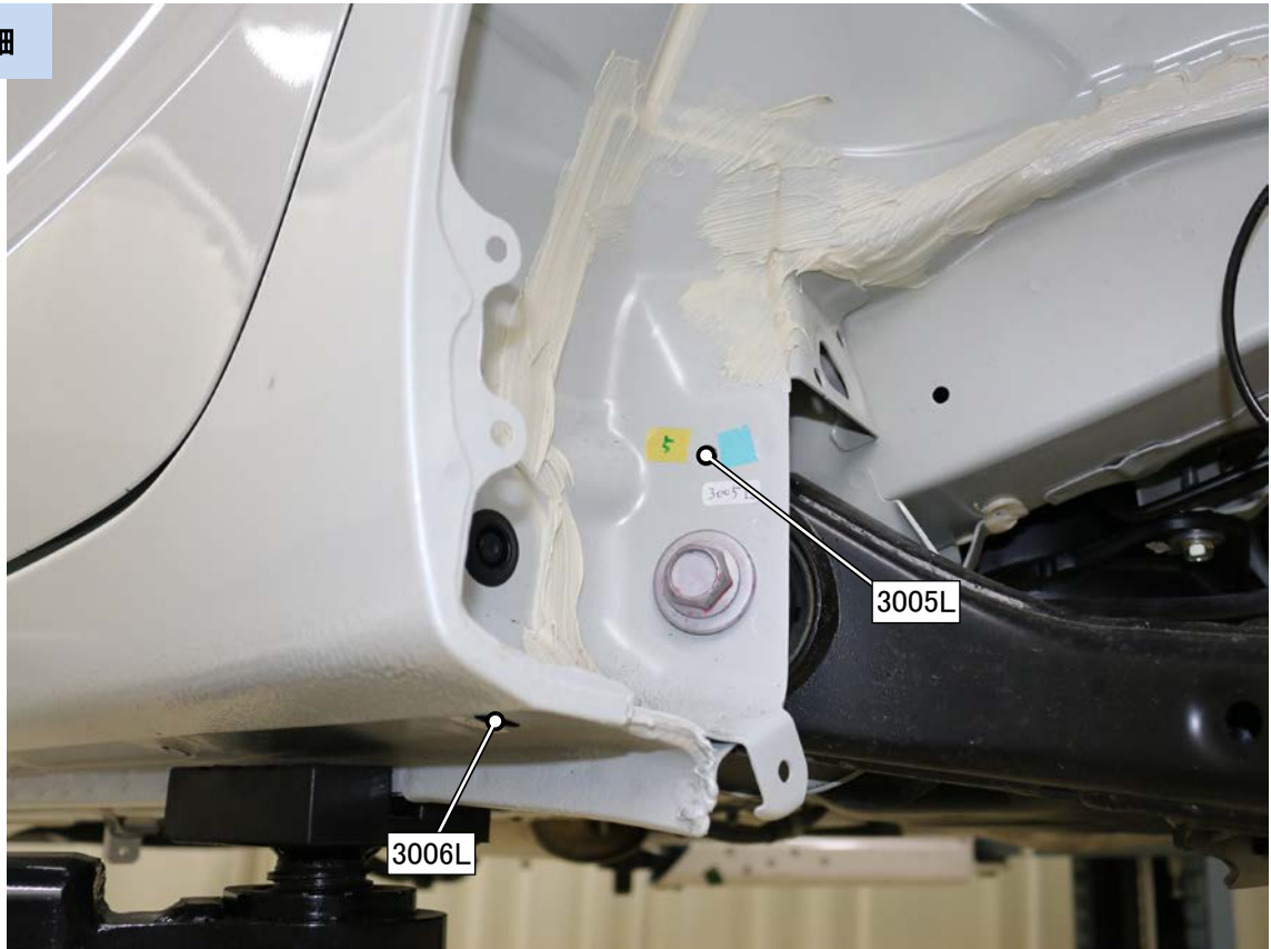
【計測点の形状】 3005L 穴、 3006L 穴
